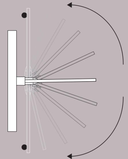
Unsere speziellen Pendeltürbänder PT60 oder PT65 sind optional für eine Montage direkt in der Leibung oder an einer Durchgangszarge geeignet. Türen lassen sich durch diese Bandsysteme in beide Durchgangsrichtungen öffnen und schwingen von selbst in ihre Ausgangsposition zurück.
